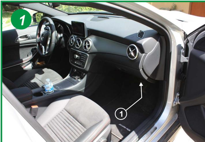
Le filtre d'habitacle est situé à l'intérieur du véhicule, côté passager sous la boîte à gants (1).
