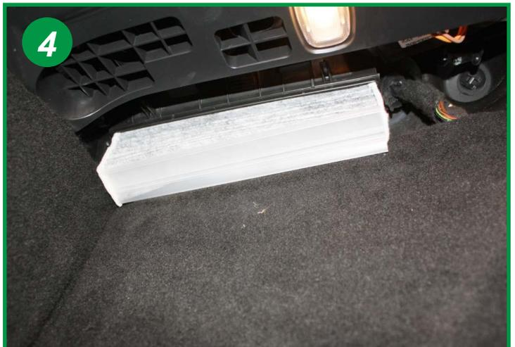
Extraire l'élément filtrant usagé en le tirant vers le bas, et le remplacer.
