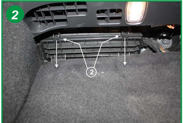
Appuyer assez fortement vers le bas (voir flèches) les 2 pattes (2) afin d'ouvrir le boîtier filtrant.
