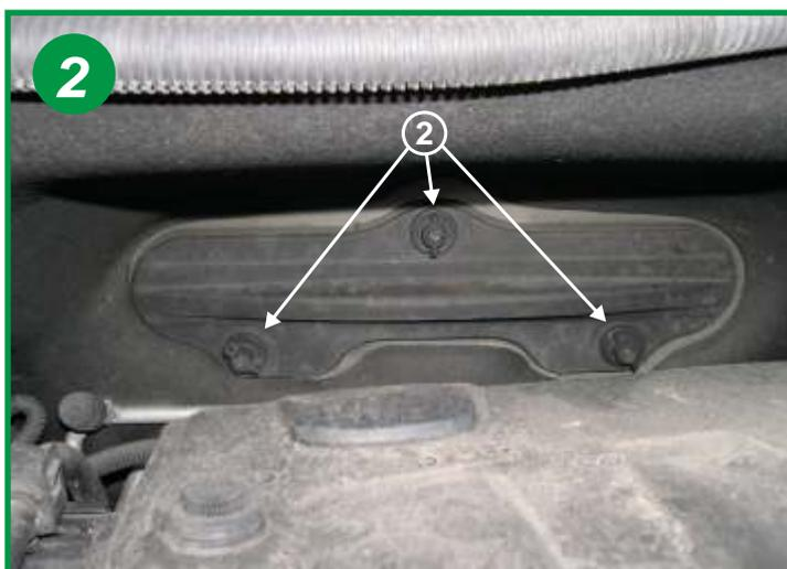
Dévisser les 3 écrous papillon en matière plastique situés sur le couvercle du boîtier filtrant (voir flèche 2).
