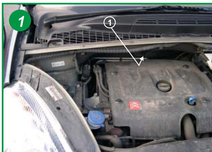
L'élément filtrant est situé sous le capot moteur coté passager (flèche 1).
