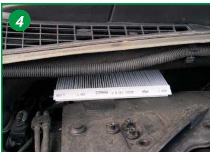
Remplacer l'élément filtrant usagé et le remplacer.
