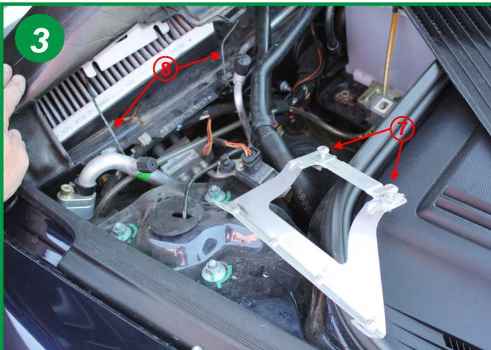
Il n'est pas nécessaire de retirer les 2 vis supérieures totalement (7).
