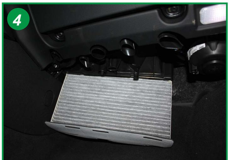
Extraire vers le bas l'élément filtrant usagé et le remplacer. Le remontage s'effectue dans l'ordre inverse du démontage.
