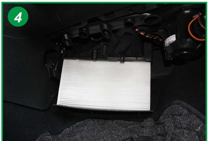
Extraire l'élément filtrant usagé vers le bas et procéder à son remplacement. Le remontage s'effectue dans l'ordre inverse du démontage.
