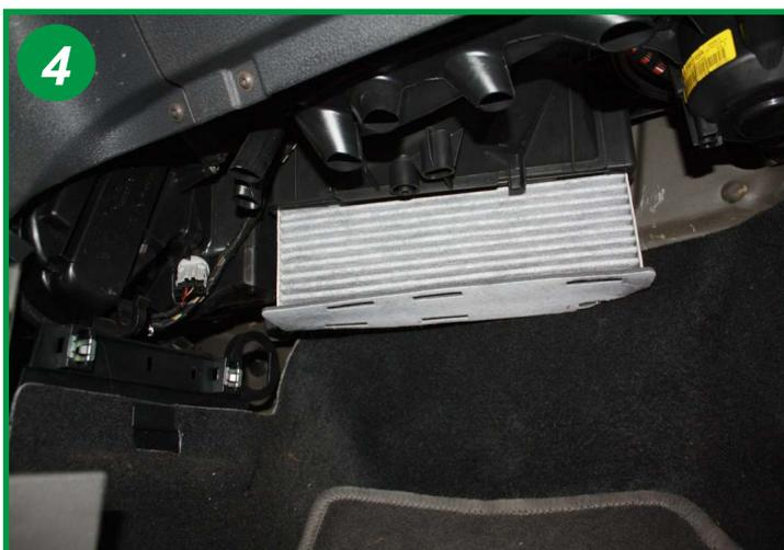
Retirer l'élément filtrant usagé et procéder à son remplacement. Le remontage s'effectue dans l'ordre inverse du démontage.
