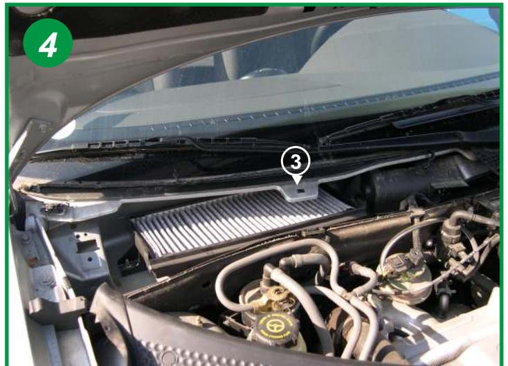
Une fois l'élément remonté dans son cadre, remonter la demi-grille d'aération en veillant à ce que sa nervure soit positionnée sous le tablier métallique et le clips plastique dans son logement (3).
