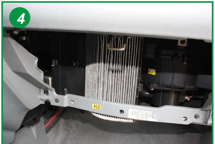
Extraire l'élément filtrant de son boîtier en le pliant, des crans segmentés sont prévus sur le filtre pour éviter de l'endommager. Le remontage s'effectue dans l'ordre inverse du démontage.
