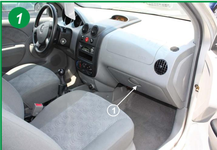
Le filtre habitacle est situé à l'intérieur du véhicule, côté passager derrière la boîte à gants (1).
