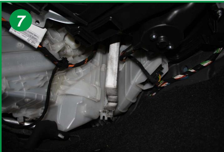
Extraire l'élément filtrant de son boîtier en le déformant.
