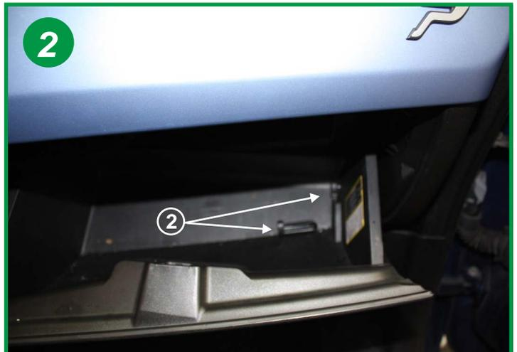
Ouvrir la boîte à gants, à l'aide d'un tournevis chasser la goupille plastique au fond à droite (2).
