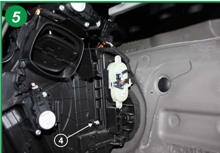
Dévisser la vis de 6 (4) afin de retirer le couvercle du boîtier filtrant.
