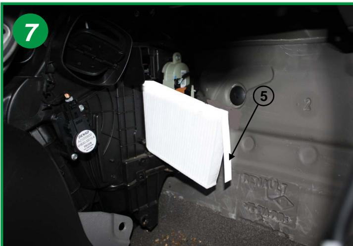
Remplacer le filtre d'origine par 2 filtres de rechange. Glisser le premier filtre dans le logement, la languette sur le devant (5). Cette languette servira au prochain changement de filtres pour les extraire de leur logement.
