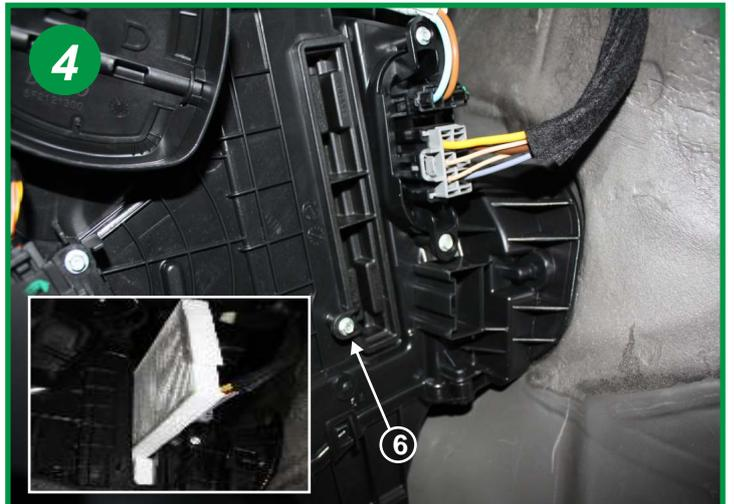
Dévisser la vis de 5,5 mm (6) et ouvrir boîtier filtrant . Procéder au changement des filtres en les plaçant l'un au dessus de l'autre ( voir encadré). Le remontage s'effectue dans l'ordre inverse du démontage.
