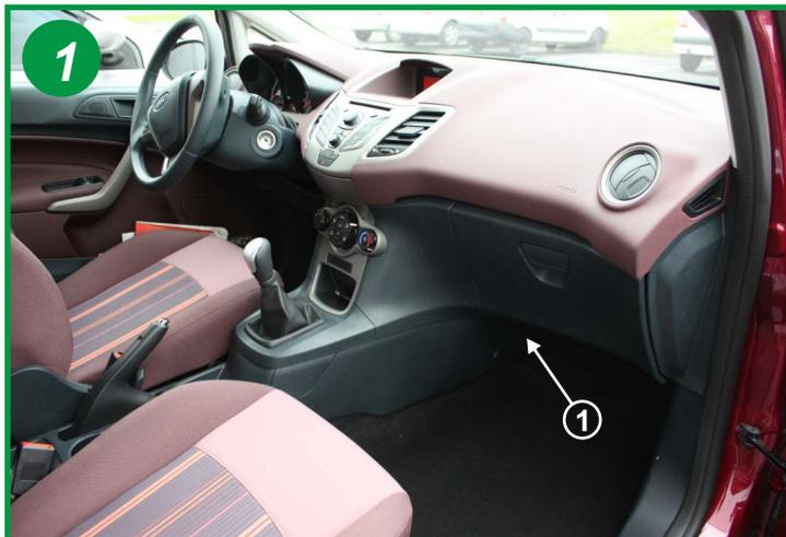
Le filtre d'habitacle est situé à l'intérieur du véhicule, côté passager derrière la console centrale (1).
