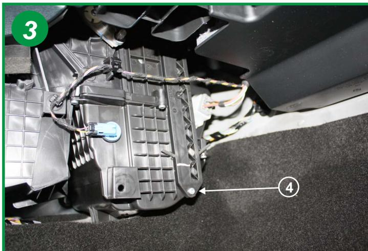
Le couvercle du boîtier filtrant est maintenu par 1 vis à sa partie inférieure (4). Dévisser cette vis Torx T25 et retirer le couvercle.
