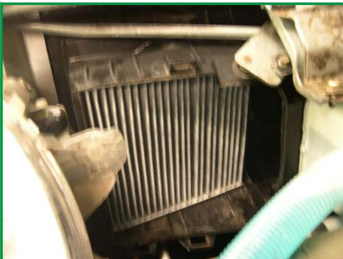
Extraire l'élément filtrant usagé et procéder à son remplacement après avoir au préalable nettoyé l'intérieur du boîtier filtrant. Le remontage de l'ensemble s'effectue dans l'ordre inverse du démontage.
