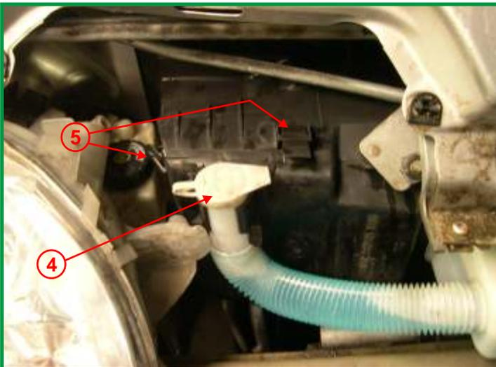
Soulever à présent la durite et le bouchon de remplissage de lave-glace (4) qui est fixé sur une glissière située sur le couvercle du boîtier filtrant. Ouvrir le boîtier filtrant en actionnant les fermetures (5). Retirer ce couvercle.
