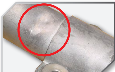
7. Deformált, hajlott, horpadt főcső
