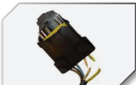
10. Sérült vagy szakadt csatlakozó
