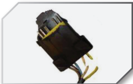
10. Poškodený alebo zlomený konektor
