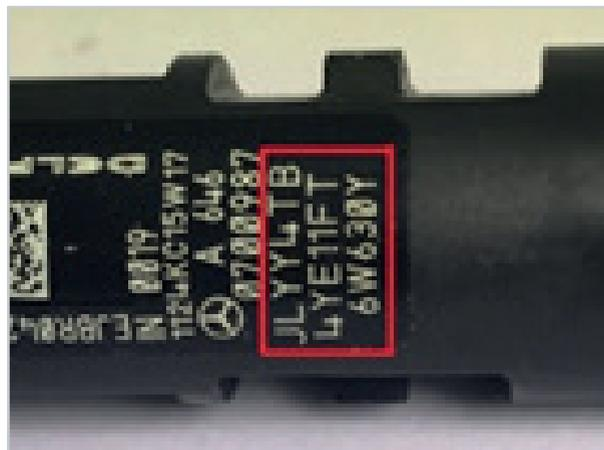
DENSO: Un código de 16 o 30 caracteres ubicado en la bobina del inyector. Después de ingresar a través del aparato de prueba de diagnóstico, se debe realizar una calibración adicional de las dosis de referencia del inyector.
