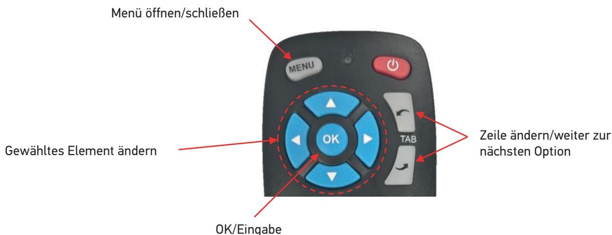
Auf die Menüfunktionen kann über die Tasten der Fernbedienung zugegriffen werden. Die "TAB"-Tasten dienen zum Wechseln zur nächsten/vorherigen Option und die Tasten "<" und ">" zur Konfiguration der ausgewählten Option.
