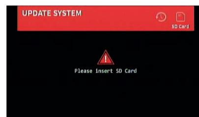
Legen Sie die SD-Karte ein, um den Upload-Prozess zu starten. Wenn die Datei "cmd" zu "update.cmd" umbenannt wurde, wird das System die neuen Daten automatisch in die ECU hochladen.
