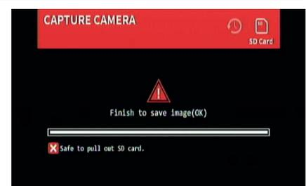
Nehmen Sie die SD-Karte aus dem Kalibrierungstool und verbinden Sie sie mit Ihrem PC, auf dem die Kalibrierung durchgeführt wird. Überprüfen Sie, dass sie SD-Karte jetzt einen "image"-Ordner im "360"-Ordner enthält und dass die Einzelbilder der Kameras (mit den Namen "front.bmp", "rear.bmp", "right.bmp" und "left.bmp") darin gespeichert sind.
