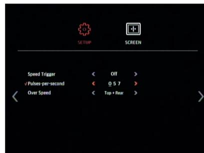
Der hier eingegebene Wert bestimmt, bei welcher Geschwindigkeit das System reagiert, wenn das Kabel für das Geschwindigkeitssignal mit dem Tachometer des Fahrzeugs verbunden wurde (Pin B8 in Europa). So verwendet z.B. ein europäischer Standard-Tachometer ein Geschwindigkeitssignal, das bei 30 mph 4 Impulse pro Meter (p/m) abgibt.
