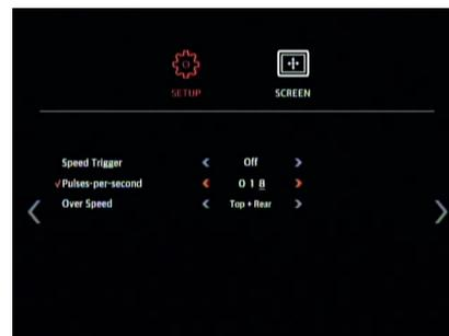
Um die Systemreaktion bei Überschreiten der gewählten Geschwindigkeit zu ändern, wählen Sie die Option für Übergeschwindigkeit mit der Tabulatortaste "nach unten". Verwenden Sie die Pfeiltasten, um die gewünschte Reaktion auszuwählen; dabei kann es sich um eine beliebige Ansicht der im System gespeicherten Ansichten halten (siehe Abschnitt 2.4 für Details zu den Ansichts-Konfigurationen) oder das Display kann deaktiviert werden.
