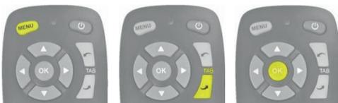
Die Einstellungen für Bildschirmgröße und Position befinden sich auf der zweiten Seite des Menüs SETUP (EINRICHTUNG). Betätigen Sie die Tabulatortaste "nach oben", um das Symbol für die nächste Seite auszuwählen und betätigen Sie OK.
