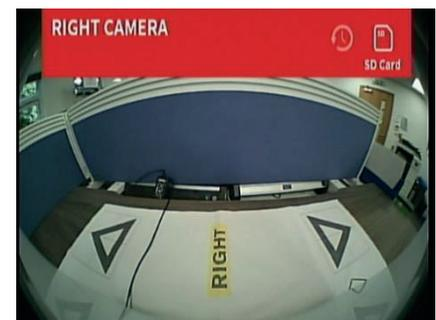
Sobald jede Kamera deutlich die Kalibrierungsmatten erfassen, drücken und halten Sie die Taste zur Ansicht-Auswahl am Schaltfeld für Set-Up & Ansicht-Auswahl für 3 Sekunden. Lassen Sie los, um die Kamerabilder zu erfassen und auf die SD-Karte zu exportieren.
