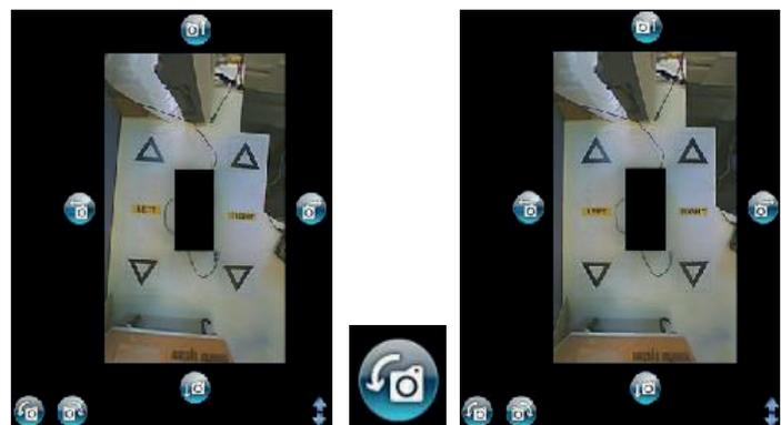
Es können horizontale und vertikale Anpassungen vorgenommen werden, um die Totwinkel der Kameras zu entfernen (rot).
