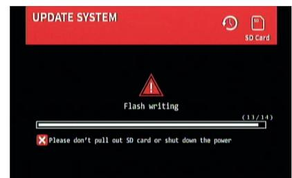
Nach dem erfolgreichen Upload wird der folgende Bildschirm angezeigt. Hinweis: Welche Elemente aktualisiert werden, hängt von den verwendeten Dateien ab (d. h. es wird nur "CALIB.INFO" angezeigt, wenn nur die Datei "param" verwendet wird, um die Kalibrierungsdaten zu aktualisieren).
