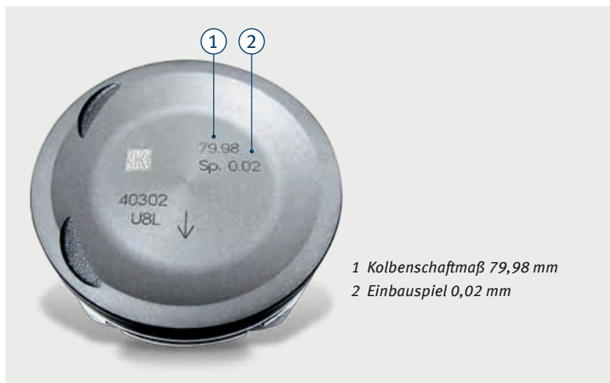
Abb. 3: Einbauspield: Angaben auf dem Kolbenboden
