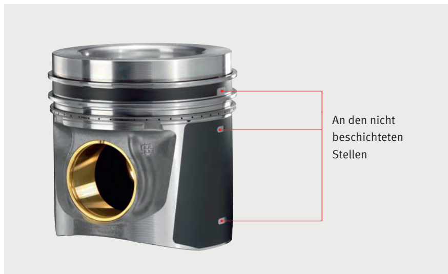
Abb. 2: Messpunkte bei Kolben mit graphitiertem Schaft
