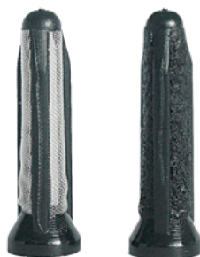
Prefiltru E1F: stânga nou, dreapta colmatat
