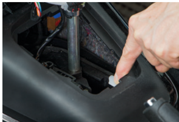
La palanca de cambios puede desbloquearse utilizando un pulsador
