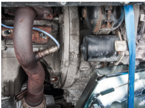
Coloque la transmisión lo más cerca posible del motor
