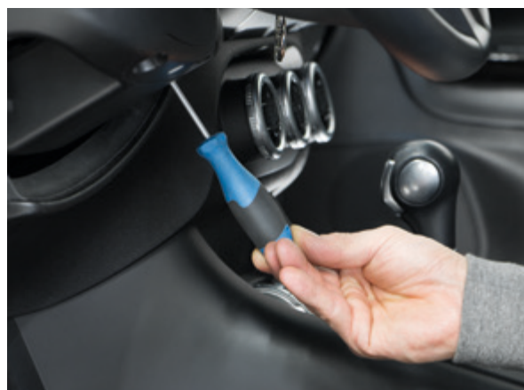
El dispositivo de bloqueo de la llave de contacto se puede anular con un destornillador
