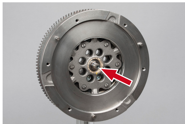
Fig. 1: Știft ghidare pe DMF 415 0377 10
