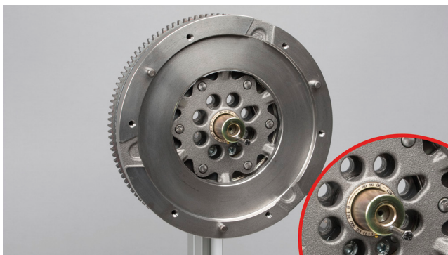
Fig. 4: Manșonul de ghidare se va monta înaintea ambreiajului (utilizați bulonul inclus în pachet)
