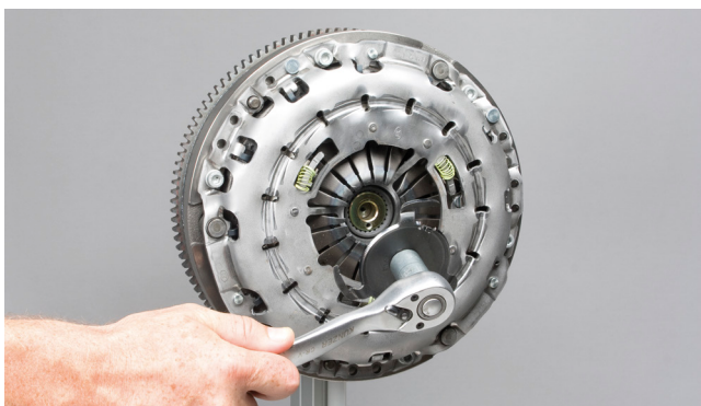
Obrázek 8: Vhodným nástrojem pootočte a vyjměte aretační přípravek. Již nebude potřebný
