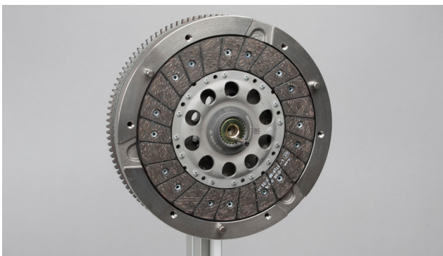
Obrázek 5: Nasadte spojkovou lamelu
