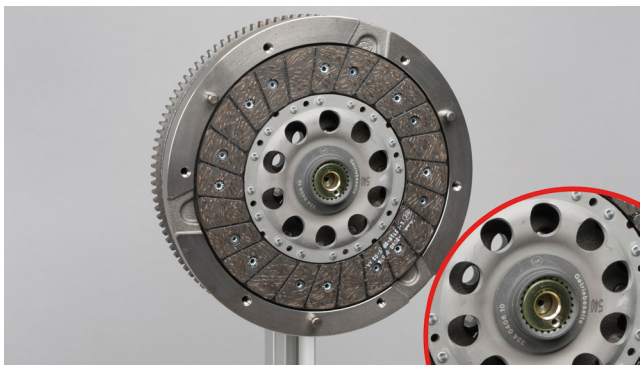
Obrázek 6: Vyšroubujte šroub ze středícího pouzdra
