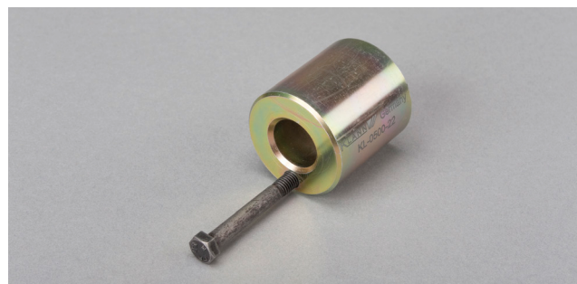
Obrázek 3: Středící pouzdro (400 0076 10) se použije u dvouhmotových setrvačnicků s vodícím čepem
