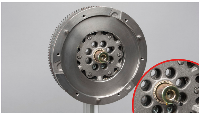
Obrázek 4: Před montáží spojky nasadte středící pouzdro (věnujte pozornost správné orientaci závitové díry pro „vytahovací“ šroub)
