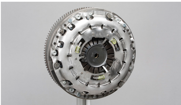
Obrázek 7: Nasadte přítláčnou kotouč spojky a šrouby dotáhněte výrobcem vozidla předepsaným utahovacím momentem
