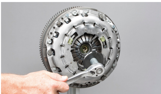
Billede 8: Brug et egnet værktøj til at dreje fastlåsningsanordningen og tage den ud. Den skal ikke bruges mere
