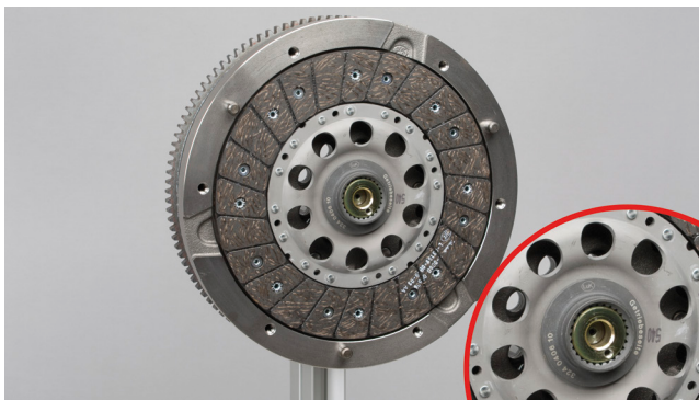
Billede 6: Skruen skal skrues fra centreringsbeholderen
