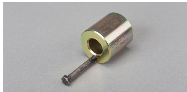
Billede 3: Centringsbøsning (400 0076 10) anvendes i dobbeltpladesvinghjul med styretap
