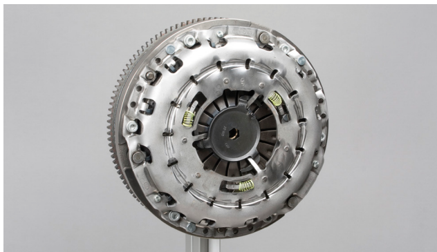
Billede 7: Koblingstrykpladen sættes på og skrue fastspændes med den af køretøjfabrikanten fastsat vridningsmoment
