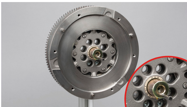
Billede 4: Inden koblingsmontering skal man sætte bøsningen på (pas på opstilling af "ekstruderingskrue")
