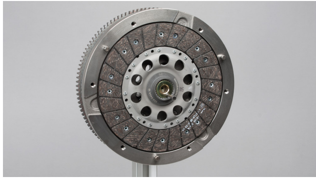
Kuva 5: Aseta kytkinlamelli paikalleen
