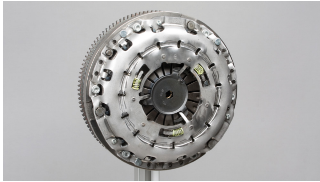
Kuva 7: Aseta kytkimen painelevy paikalleen ja kiristä ruuveilla ajoneuvon valmistajan esittämällä kiristysmomentilla
