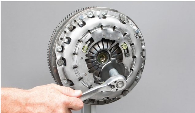
Kuva 8: Poista painelevyn lukitusholkki kääntämällä asianmukaisella työkalulla, sitä ei enää tarvita.
