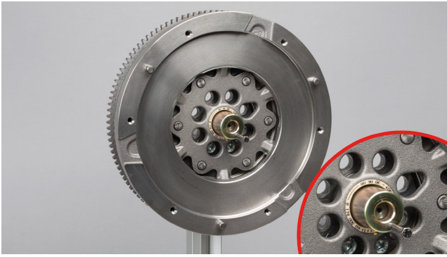
Kuva 4: Aseta keskitysholkki paikoilleen ennen kytkimen asennusta. (ruuvitappi holkin kärjessä)
