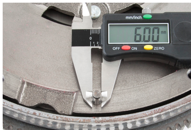
Εικόνα 1: Μέτρηση διαμέτρου πείρου κεντραρίσματος
