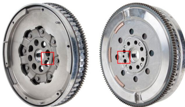
Figura 1: Marcação de referência no volante bimassa
