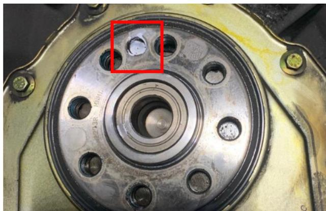
Figura 2: Marcação de referência na cambota
