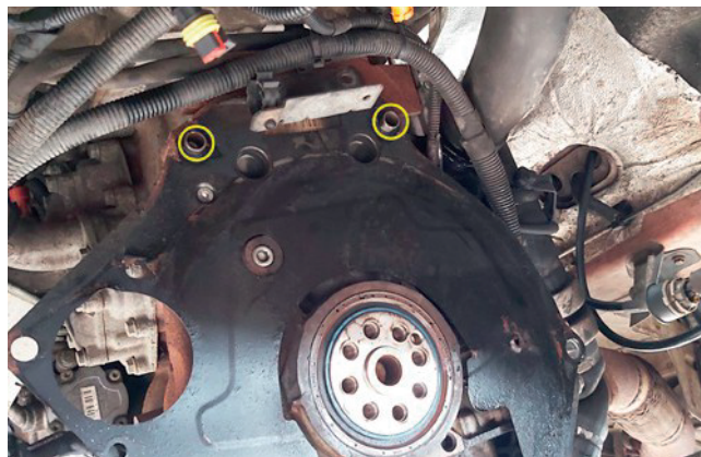
Rysunek 1: Kołki centrujące na bloku cylindrów
