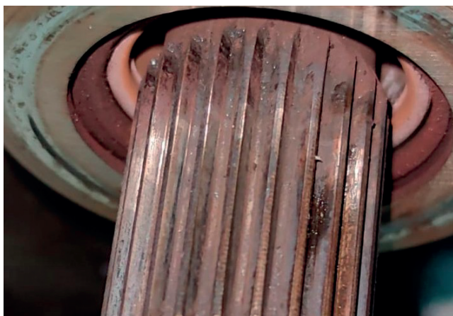
Rysunek 3: Wał wejściowy skrzyni biegów ze widocznym zużyciem wieloklinu
