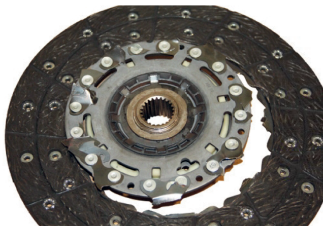
Rysunek 2: Uszkodzona piasta tarczy sprzęgła
