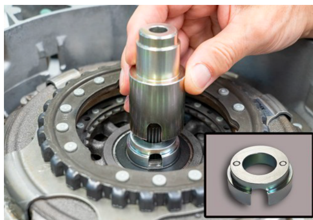
Rysunek 1: Tuleja wciskana w połączeniu z adapterem KL-0500-6031 Z LUK
