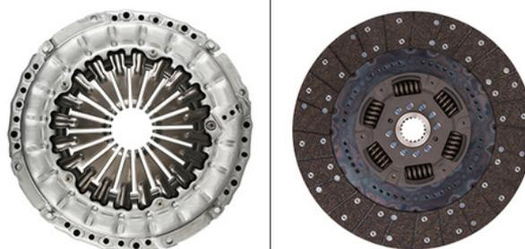
Figura 1: Conjunto de embraiagem 640 3014 09 (para veículos com impulsionador de embraiagem)
