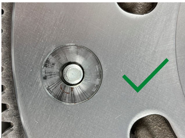
Зображення 4: Правильне / відцентроване положення шпильки зчеплення в отворі маховика
