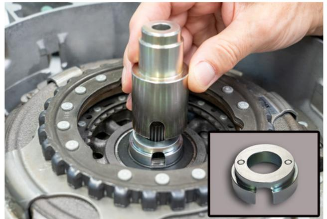
Figure 1 : Mandrin de montage associé à l'adaptateur KL-0500-6031 Z LUK
