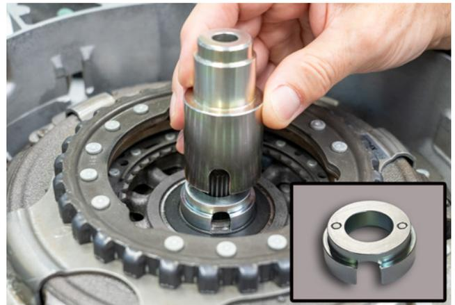
Figura 1: Manga de encaixe em combinação com o adaptador KL-0500-6031Z LUK
