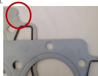
A diferencia de la junta estándar, esta junta, tal y como se aprecia en la imagen, posee una muesca adicional en la perta frontal, que es claramente visible en estado montado.
