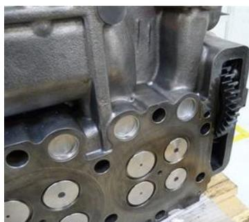
**Superficie de estanqueización de la culata con rueda dentada recta**
