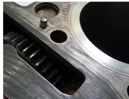
**Superfícies de vedação do bloco do motor com roda dentada**
