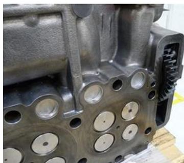
**Superfície de vedação do cabeçote com roda dentada**
