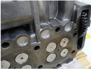
Superfície de vedação do cabeçote com roda dentada
