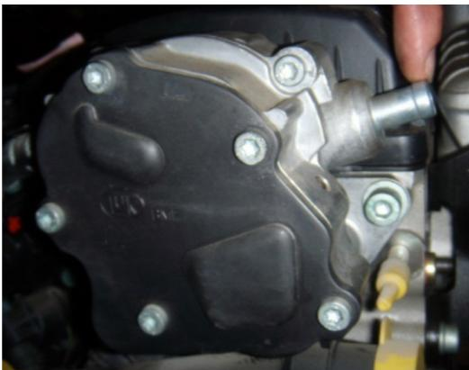
Esta quantidade de ar introduzida no interior do respirador do motor impede o correto retorno de óleo do cartucho para o bloco do motor, motivo pelo qual se verifica a sua saída atravessando os segmentos de escape e de admissão para o interior dos caracóis, parecendo um problema típico de desgaste ou defeito do turbo que realmente não existe.
