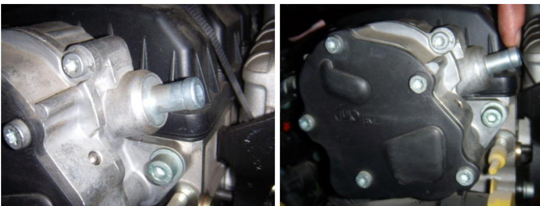
A levegő bejutása a motor légtelenítőjébe megakadályozza, hogy a patronban lévő olaj megfelelően visszajusson a motorblokkba. Az olaj ezért a szívó- és kipufogó dugattyúgyűrűkön keresztül a kompresszor- és turbinaházakba szivárog, ami tipikus turbókopási problémának vagy turbóhibának tűnik, holott valójában nem erről van szó.
