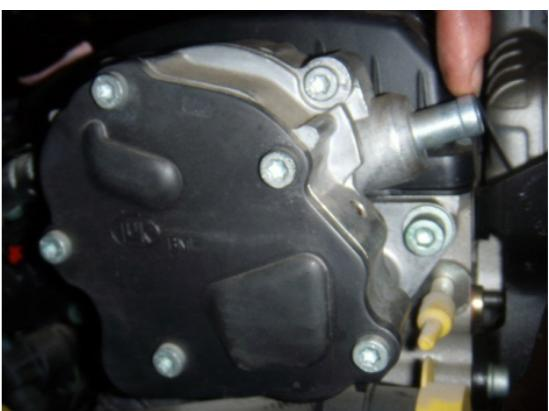
Cette quantité d'air introduite à l'intérieur du reniflard du moteur empêche le retour d'huile approprié de la cartouche sur le bloc moteur, de sorte qu'il s'échappe à travers les segments d'échappement et d'admission à l'intérieur du turbo, qui ressemble à un problème typique d'usure du turbo, ou à un défaut du turbo, qui n'existe pas réellement.
