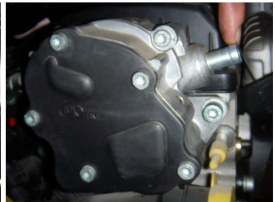
Questa quantità d'aria introdotta all'interno dello sfiato motore, impedisce il corretto ritorno dell'olio dalla cartuccia al blocco motore, per cui questo esce attraversando i segmenti di scarico e di aspirazione all'interno delle loro conchiglie, sembrando un problema tipico di usura del turbo, o difetto del turbo quando in realtà non esiste.
