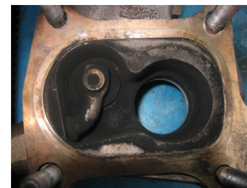
Falsch montierte Dichtung
