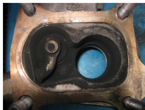
Junta montada incorretamente
