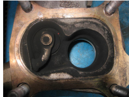
Junta montada incorrectamente
