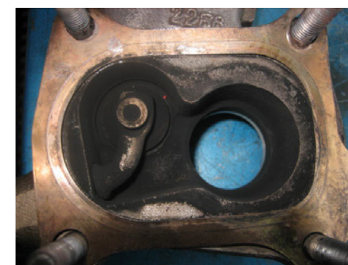
Garnitură montată incorect
