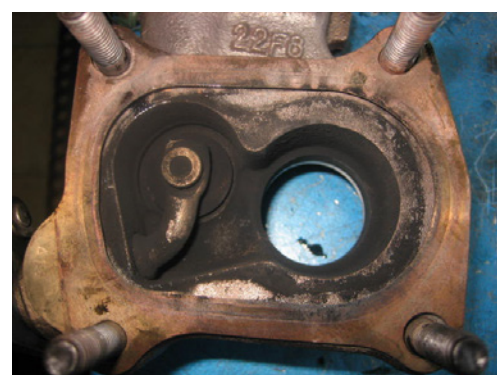
Junta montada corretamente
