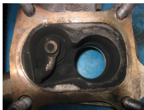
Nesprávně namontované těsnění
