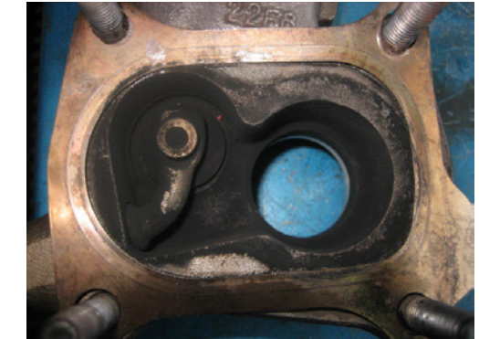
Guarnizione montata non correttamente
