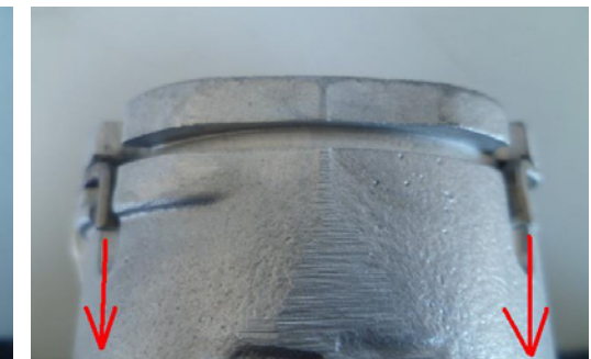
Beide Stifte zeigen in dieselbe Richtung
