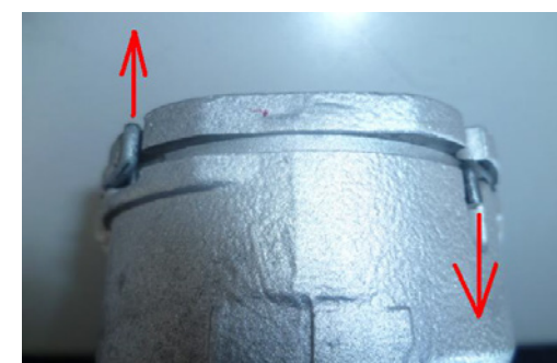
Vârfurile sunt orientate în direcții opuse
