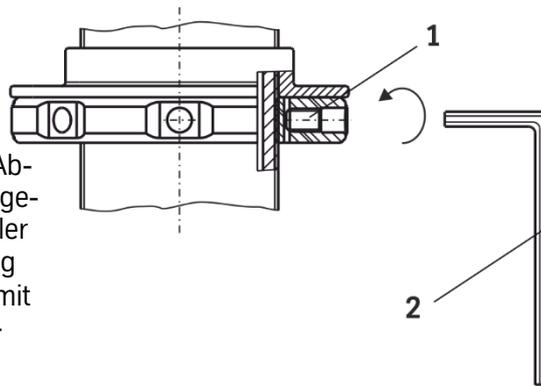
Die Höhenverstellung, wie in der Abbildung der jeweiligen Achsen dargestellt, komplettieren. Den Federteller mit dem im BILSTEIN Lieferumfang enthaltenen Gewindestift (1) und mit Hilfe des mitgelieferten Innen-6kt-schlüssels (2) sichern.
