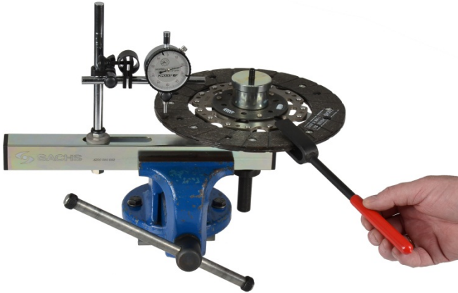
Abb. 8: Seitenschlagprüfgerät komplett montiert
