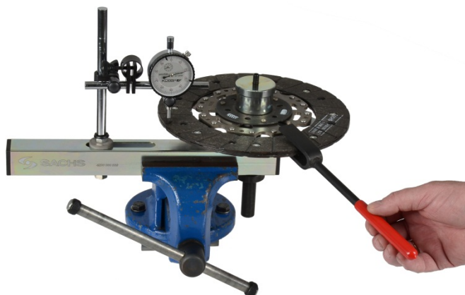
Fig. 8: comprobador de desviación lateral completamente montado
