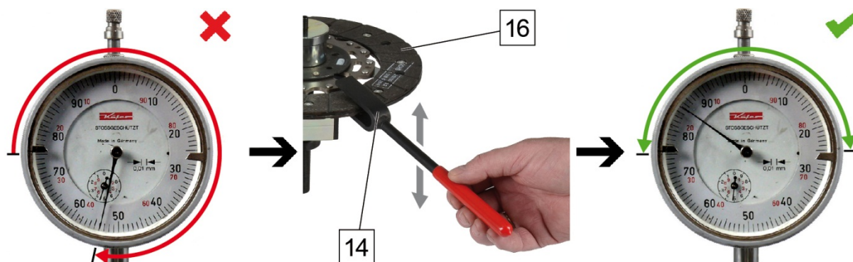
Fig. 10: alineamiento del disco de embrague
