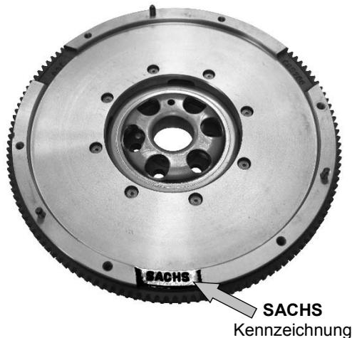
**Abb. 2:** Sonderbauformen von Zweimassenschwungradern können konstruktionsbedingt **nicht geprüft** werden!
