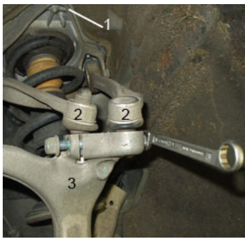
Fig. 1: 1 Montageclip / Mounting clip / Clip de montage / Clip de montage 2 Obere Lenker / Upper links / Bras supérieurs / Dirección superior 3 Achsschenkel / Steering knuckle / Fusée d'essieu / Cuello del eje
