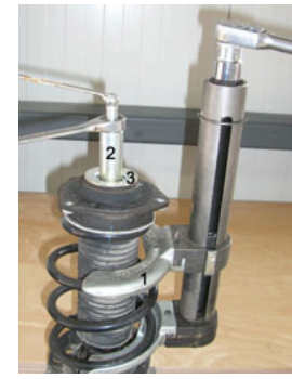
Fig. 3: 1 Federspanner / Spring tensioner / Monte-ressort / Tensor de resorte 2 Spezial Werkzeug / Special tool / Outil spécial / Herramienta especial 3 Oberes Federbeinlager / Upper strut bearing / Palier supérieur de jambe de force / Apoyo superior de la columna de suspensión
