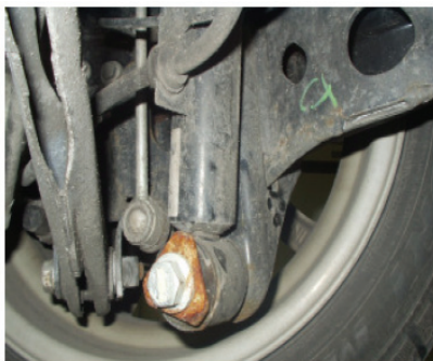
Fig. 8: Untere Befestigungsschraube(n) / Lower fastening screw(s) / Vis de fixation inférieure(s) / Tornillo(s) de fijación inferior(es)
