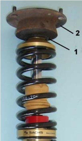
Fig. 2 1 Beilagscheibe / Washer / Rondelle de calage / Arandela 2 Stützlager / Support bearing / Palier de soutien / Cojinete de apoyo
