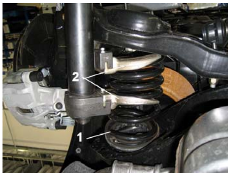
Fig. 7: 1 Fahrzeugfeder / Vehicle spring / Ressort du véhicule / Muelle del vehículo 2 Federspanner / Spring tensioner / Tendeur de ressort / Tensor de muelle
