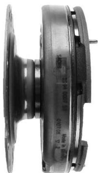
**Volant bimasse pour boîte de vitesses à double embrayage**
