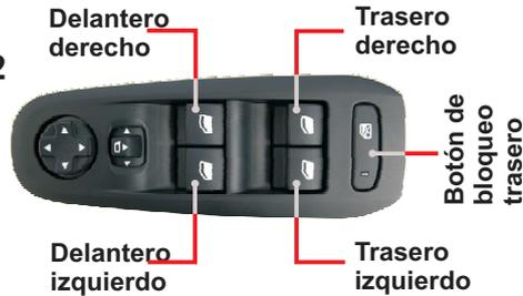
**Después de instalar el elevallas:** como se trata de un sistema LIN Bus, es necesario proceder con la asignación del motor a la puerta donde hemos reemplazado el elevallas pero **actuando exclusivamente desde el mando del lado del conductor (Foto 2)**.
