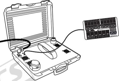
**DE** FUNKTIONEN KONTROLLIEREN MIT EINEM PRÜFGERÄT MIT WIDERSTAND ODER MIT LEUCHTEN MIT DER GENAUEN WATTZAHL!
