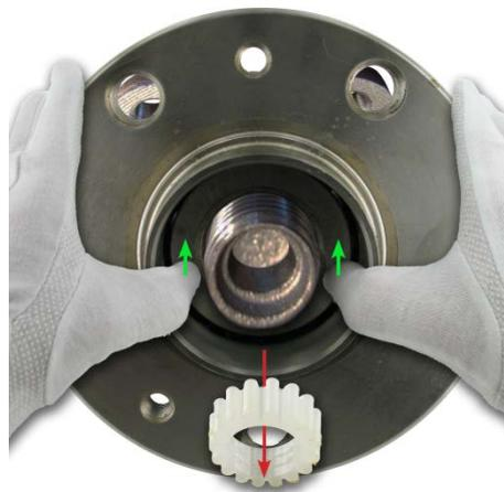
L'anello di sicurezza in plastica, verrà eliminato automaticamente dal fusello quando il cuscinetto verrà montato in modo corretto, applicare la forza sull'anello interno. Non rimuovere l'anello di sicurezza manualmente prima del montaggio del cuscinetto.
